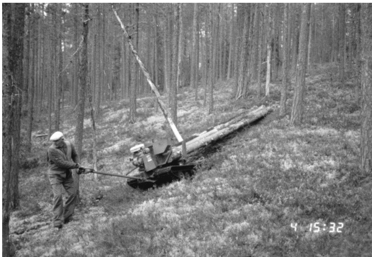
Timmer valdes på rot när Hedbodarna rustades omkring 1990. På bilden ser vi Ragnar Forslund dra timmer med en järnhäst vid Påderforsen i Vanån. Foto: Bertil Persson Bildkälla: Elfdalens hembygdsförenings bildarkiv.
