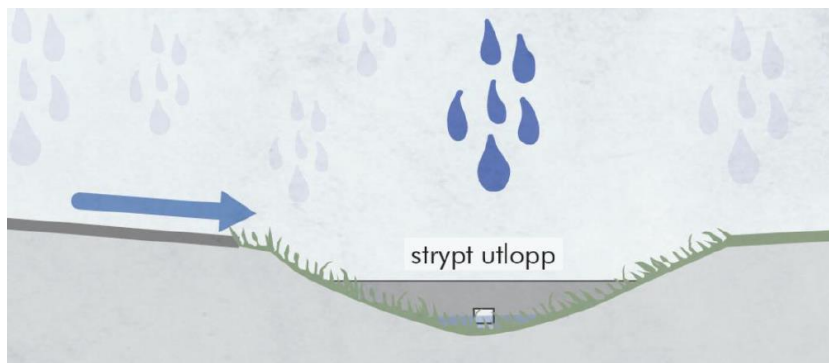
Figur 13. Principskiss för svackdike med strypt utlopp (Illustration: Sweco)
