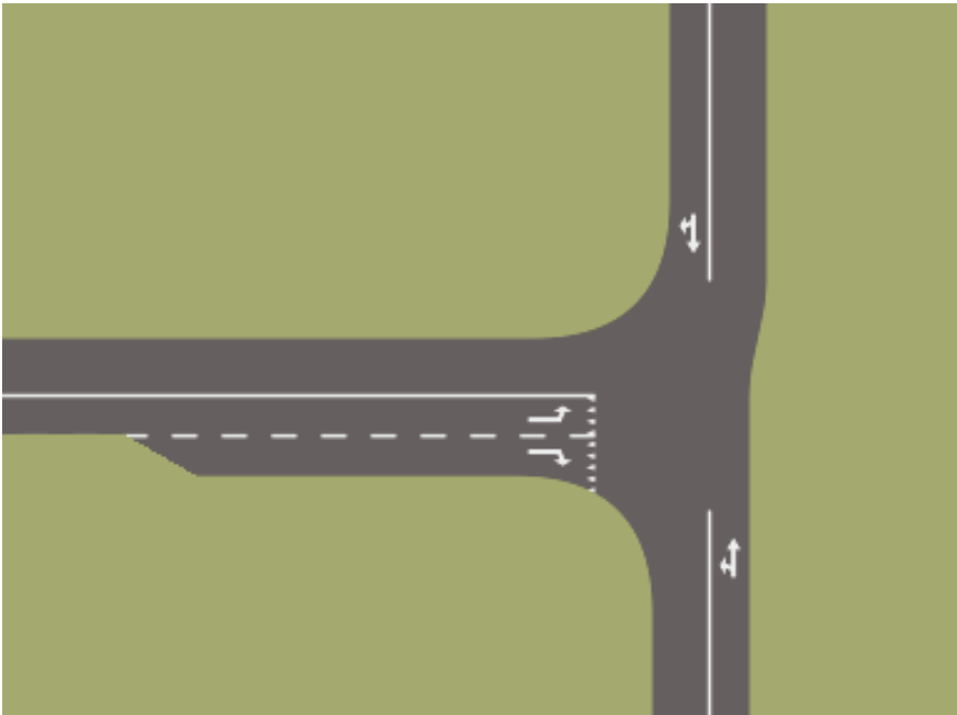
Figur 10 Förslag på trimningsåtgärder vid över 30% trafikökning.
